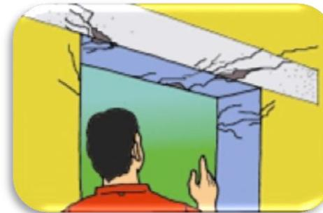
\*Viga que se coloca en la parte superior de puertas y ventanas
